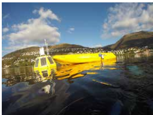
Figur 4 Målebøyen Gabriel i Store Lungegårdsvann i Bergen er en lokal datakilde som hver tredje time måler temperatur, saltholdighet, oksygennivå og uklarhet i vannet fra overflate til bunn.
