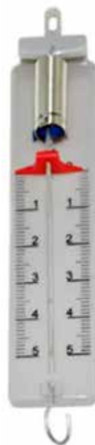
Bilde 2: Kraftmåler – dynamometer Kroken henges i en virvel, og toppen må kunne festes i en spiker.
